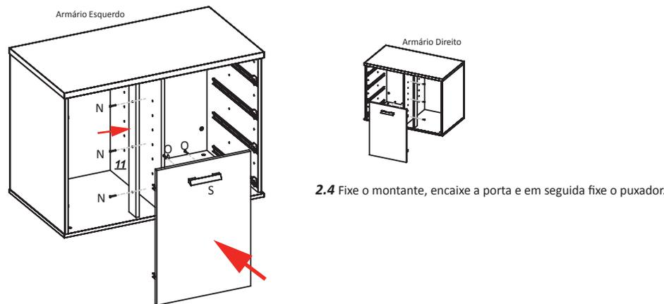
**2.4** Fixe o montante, encaixe a porta e em seguida fixe o puxador.
