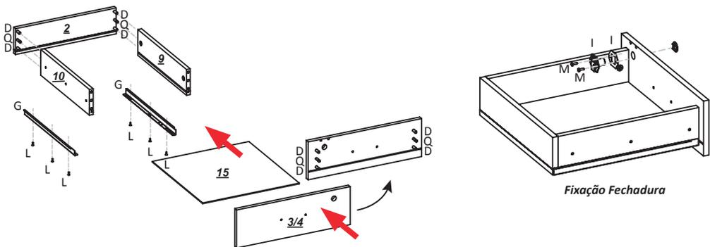
**1.7** Insira os pinos minifix e cavilhas no fundo e nas frentes. Encaixe as laterais e trave os tambores. Encaixe o fundo 3mm no canal das laterais, posicione a frente e trave os tambores. Por fim, fixe as corrediças com os parafusos indicados na imagem.
